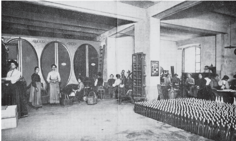
Reparto imbottigliamento nello stabilimento Gancia: dai tini in cemento e vetro a damigiane e bottiglie, primo '900
